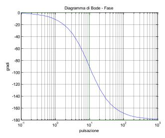
La pulsazione di taglio risulta  $\omega_c=100$  rad/s e il margine di fase risulta circa pari a 10°. Si ottiene che, per quanto riguarda il sistema ad anello chiuso, l'approssimazione a poli dominanti prevede due poli complessi coniugati aventi pulsazione naturale  $\omega_c$  e smorzamento  $\xi \approx \frac{\varphi_m}{100} = 0.1$ . La funzione di sensitività complementare approssimata è
