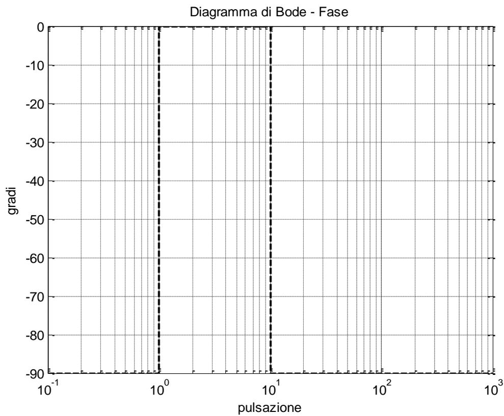
*Dai diagrammi si ottiene che  $\omega_c = 100 \text{ rad/s}$  e  $\varphi_m > 90^\circ > 75^\circ$ . Grazie a quest'ultima proprietà possiamo approssimare la funzione di sensibilità complementare cercata con*
