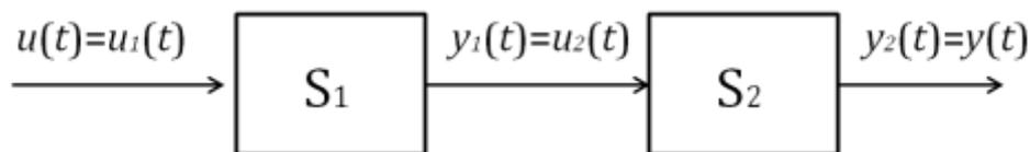
In quanto il sistema in figura è costituito dalla cascata dei sistemi  $S_1$  e  $S_2$ , esso risulta semplicemente stabile.
