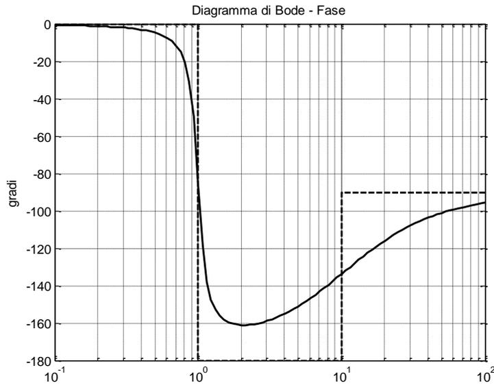
Si calcola facilmente che  $-180^\circ < \varphi_c < -90^\circ$ . In particolare  $\varphi_c \cong \angle L(j3) = \angle(1 + j0.3) - \angle(-8 + j0.6) = 16.7^\circ - 175.7^\circ = -159^\circ$ . Da questo deriva che  $\varphi_m = 180 - |\varphi_c| \cong 21^\circ > 0$ . Dato che, inoltre,  $\mu > 0$ , il criterio di Bode garantisce che il sistema ad anello chiuso corrispondente è asintoticamente stabile.
